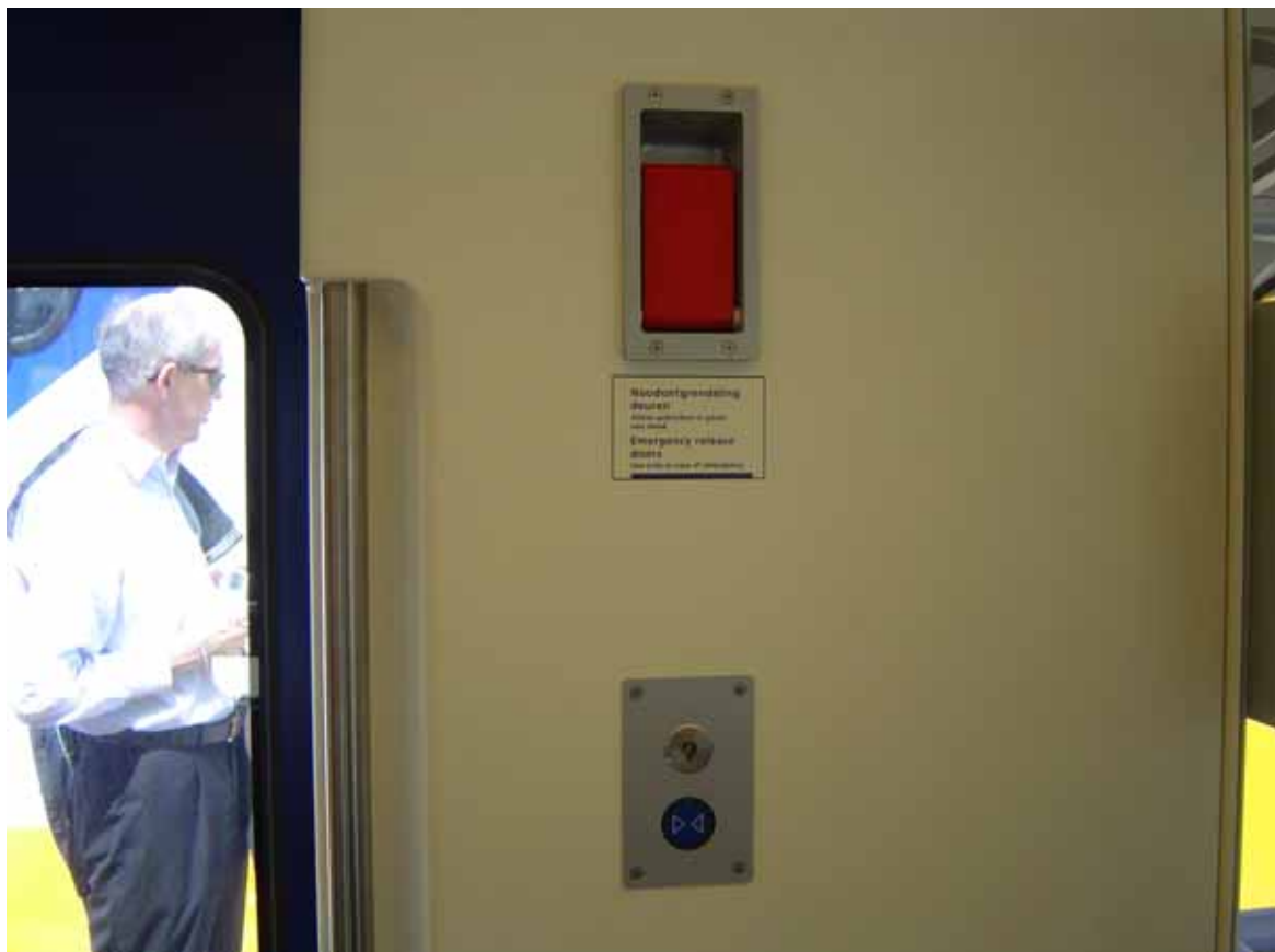
Onder de noodontgrendeling bevindt zich de knop om de deuren te sluiten. Op de deuren zelf is de knop gemaakt om de deuren te openen.
