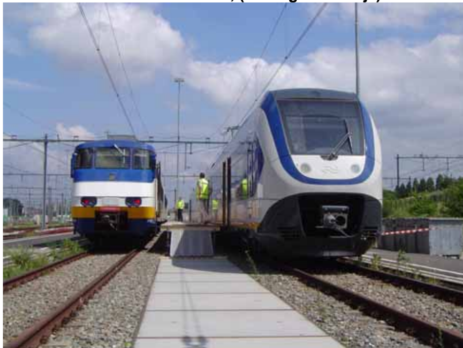
Moderne trein met veel snufjes, modern uiterlijk. Er zitten nog wel wat kinderziektes in. Bijv. om aan het ATB-remcriterium te voldoen dient er redelijk fors geremd te worden. Dit veroorzaakt vertragingen zodat dit nog via de software verbeterd dient te worden.
