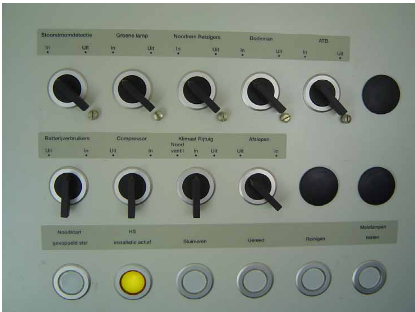
Achterwandpaneel. Bevindt zich op de rechterachterwand achter de machinist. Met schakelaars voor onder andere: dodeman, ATB, compressor, klimaatregeling rijtuigen, afslepen, noodstart gekoppeld stel, meldlamp HS, sluimerstand, gereed continu, reinigen en de knop meldlampen testen.
