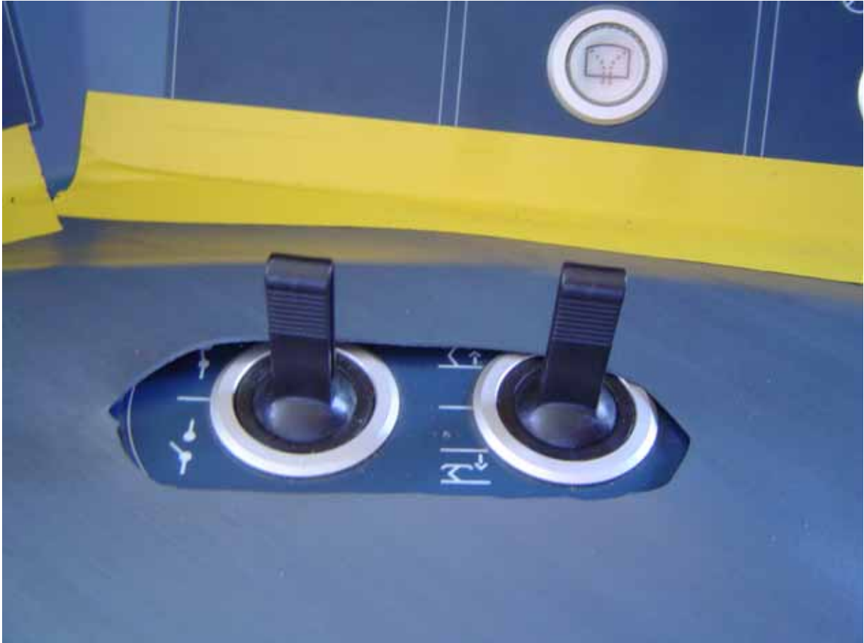
Links de snelschakelaar, rechts de schakelaar stroomafnemer op of stroomafnemer neer.
