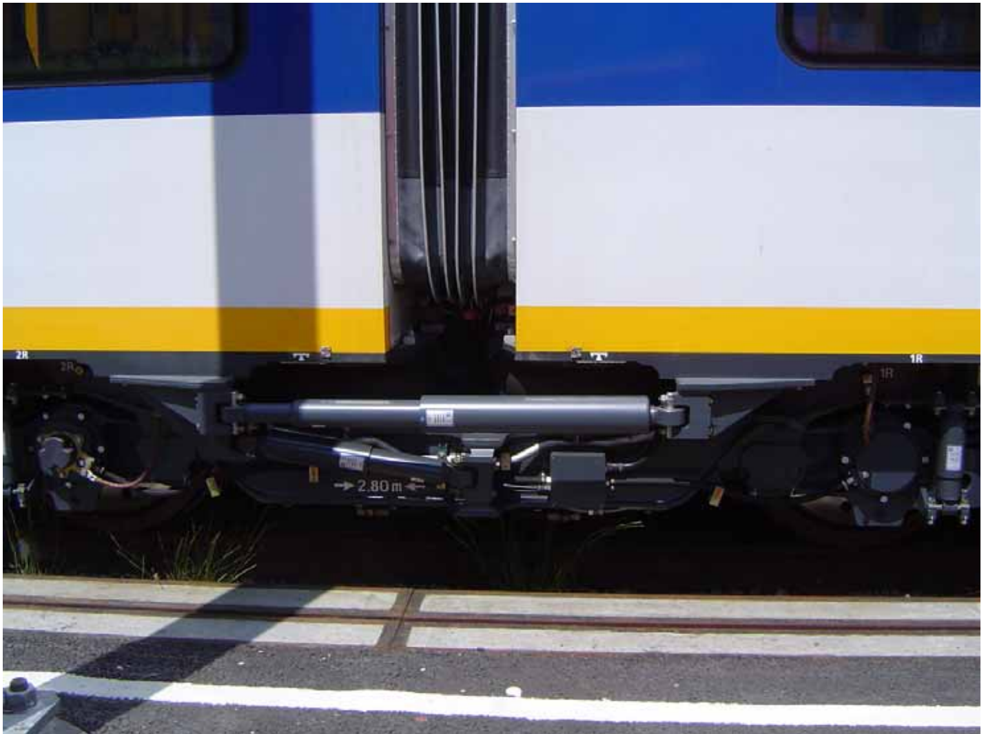
De draaistellen verbinden tevens 2 bakken met elkaar, net zoals bij de ICE.
