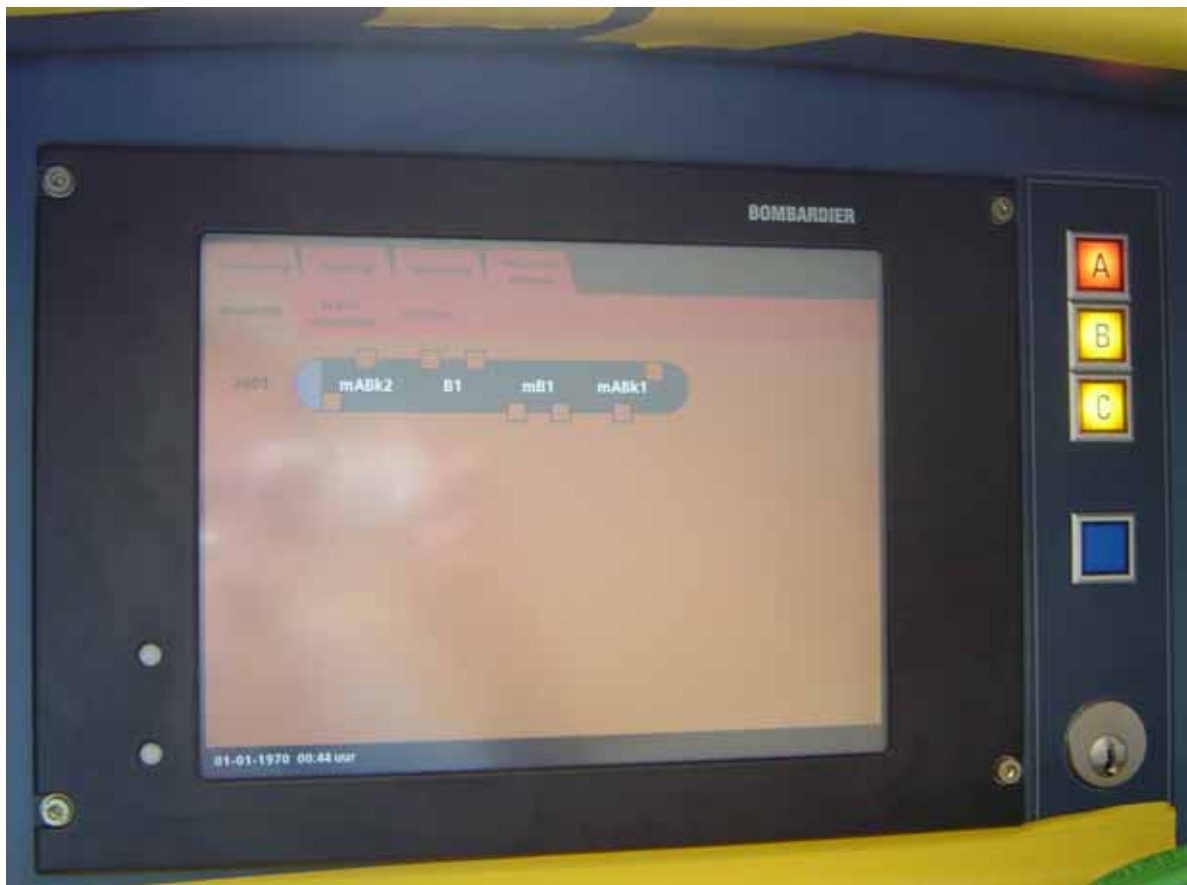
Diagnosescherm (lijkt heel erg op (V)IRM met daarnaast lampen stringen, lamp dodeman en slot voor stuurstroomcontact.
