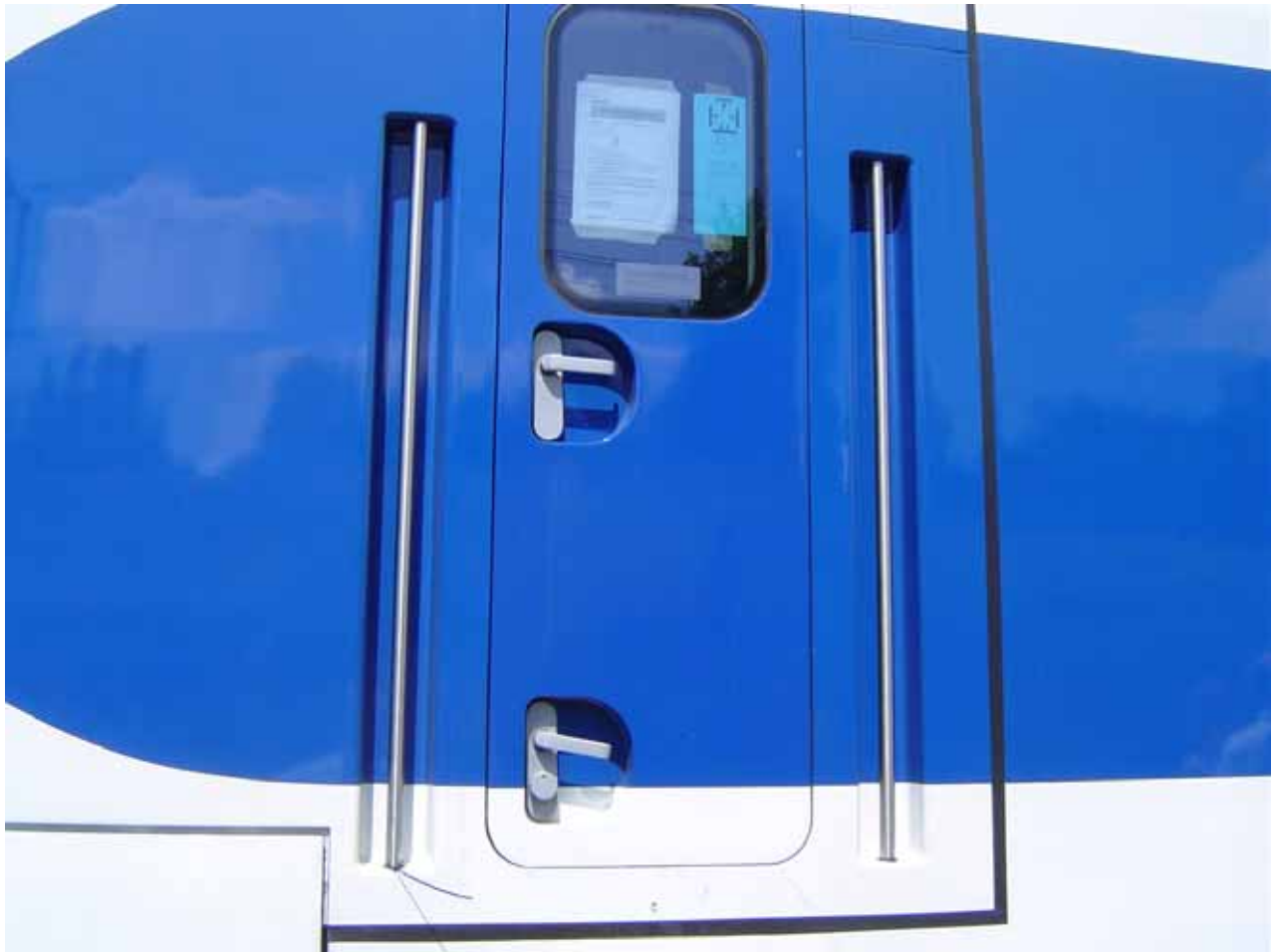
Deur van de cabine: de stangen zijn verwerkt in de wand van de trein en steken dus niet meer uit.
