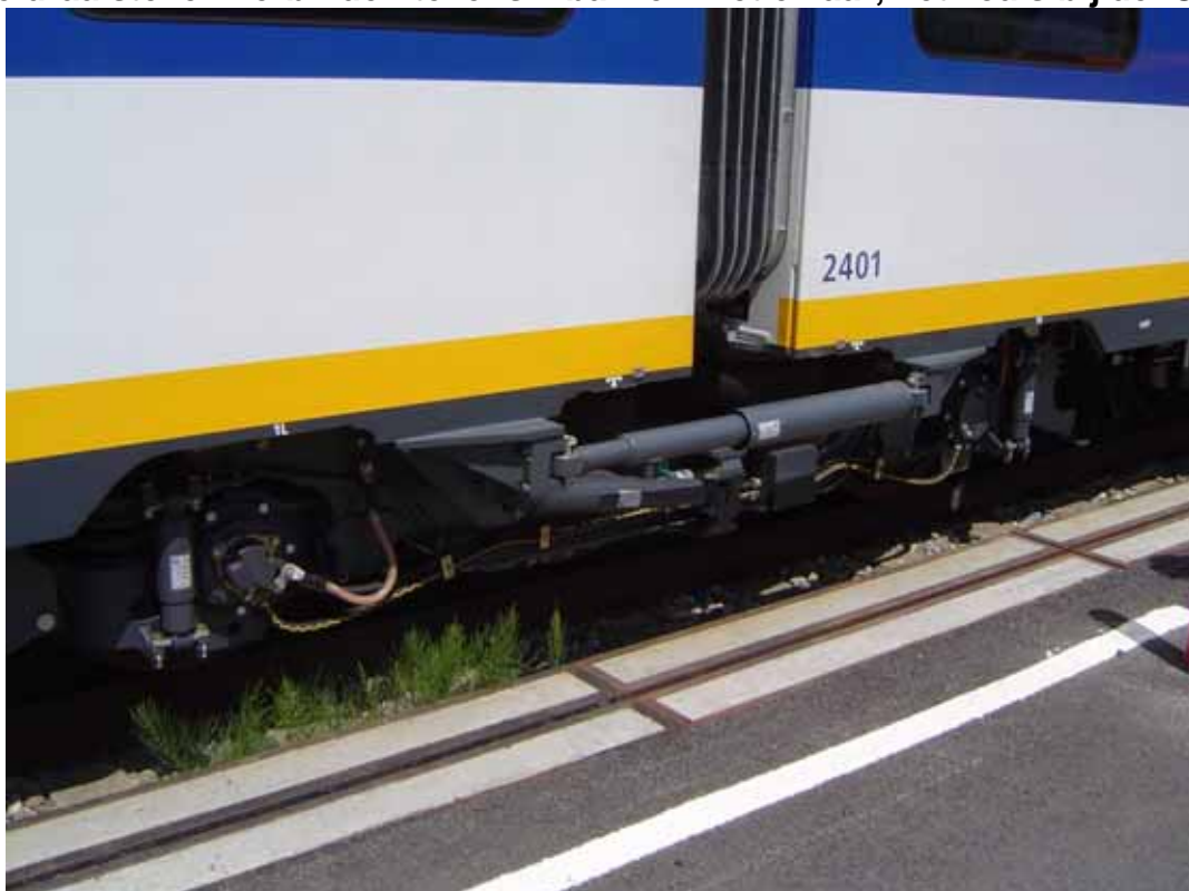
De draaistellen verbinden tevens 2 bakken met elkaar, net zoals bij de ICE.
